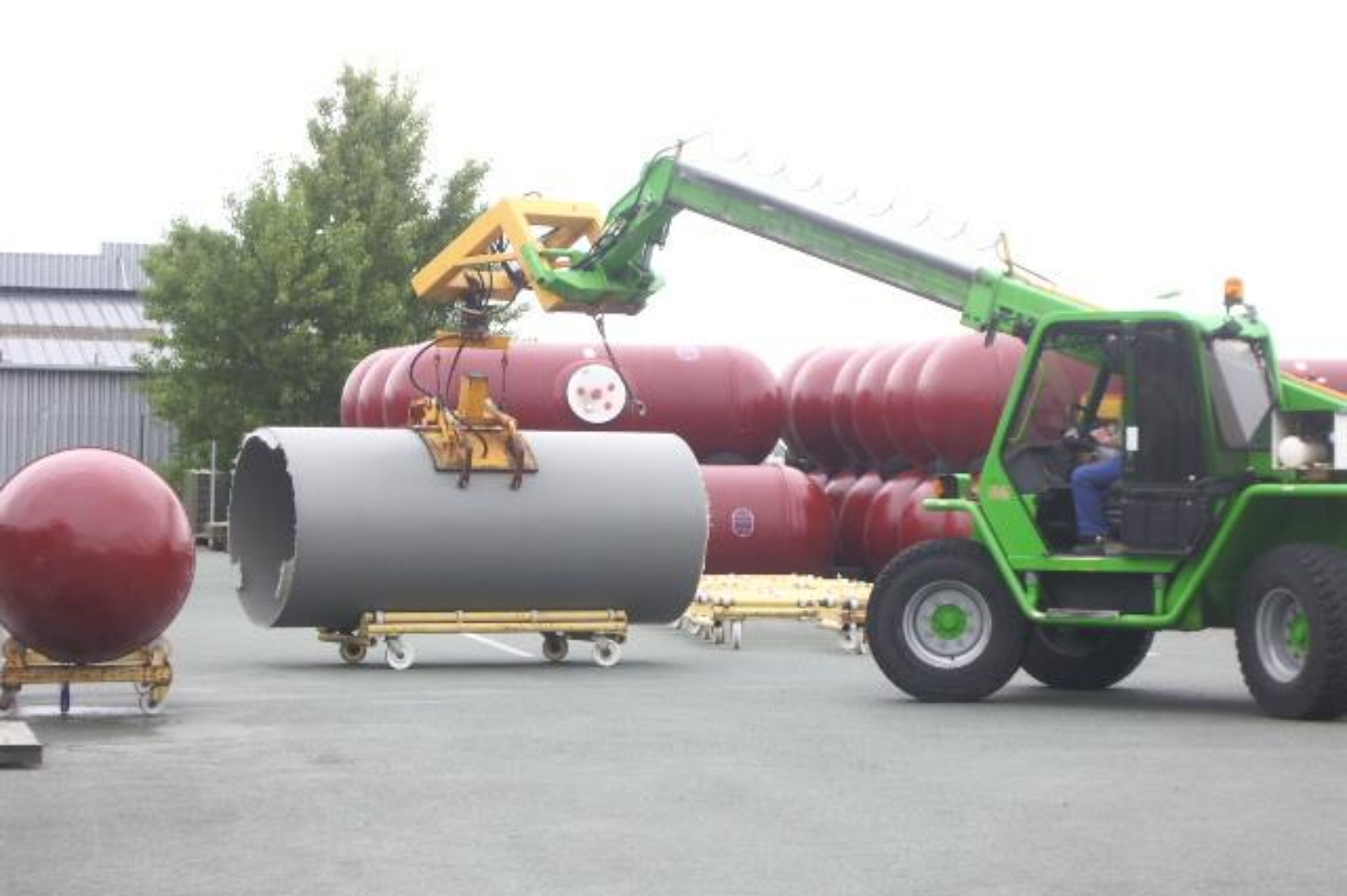
Sewer pipes 3m long & 68 inches & 2,5 T
